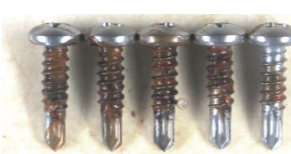
一般処理 パシベート処理品 5本中5本に重度の赤錆発生
