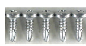
木くぞう用処理 サスガードSG処理品 5本中赤錆発生0本
