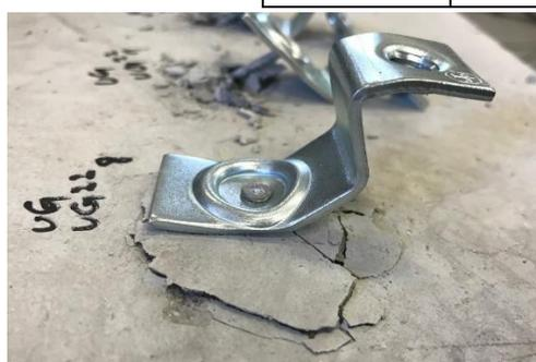
図 8 高荷重破壊典型
