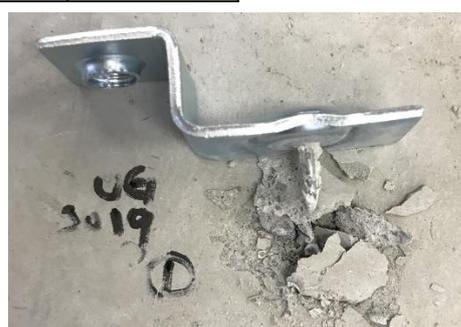
図 9 低荷重破壊典型
