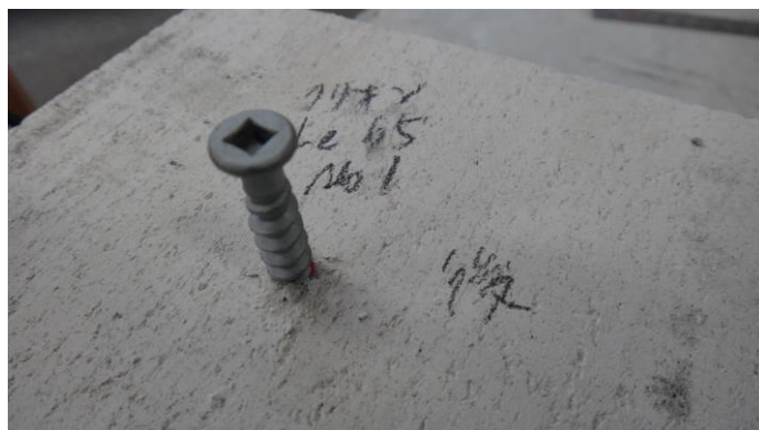
写真5. 破壊形態(試料抜け出し)例
