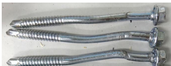
写真4 試験後の試料変形状態
