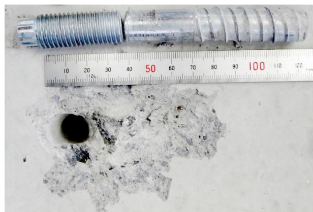
図12:破壊形態例 アンカー破断
