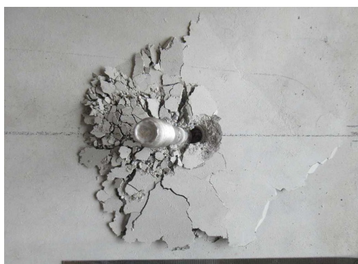
図7-8. 実体せん断 STP II-1210破壊形態
