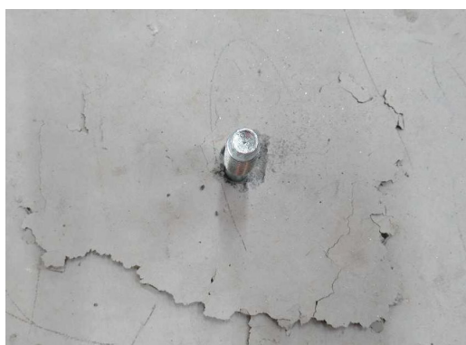
図7-2. 実体引抜 TP II-1210破壊形態
