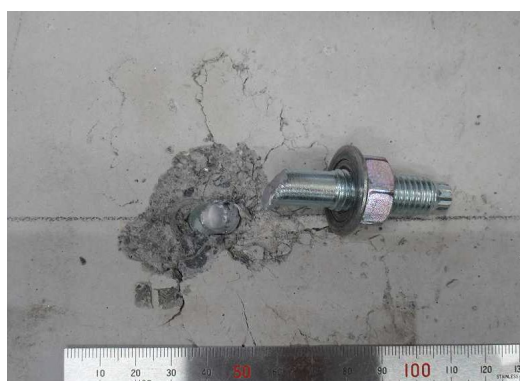
図7-9. 実体せん断 TP II-1210破断
