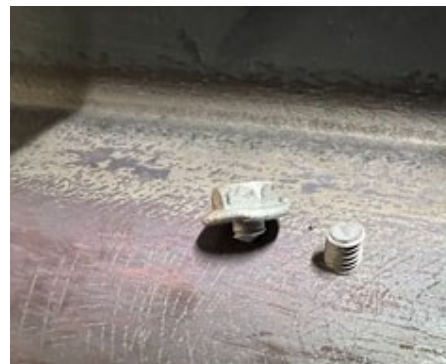
写真 6. 破壊形態 軸部破断
