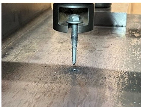
写真 5. 破壊形態 試料抜け (代表例)
