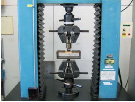
図 1 0 . 構造用合板の試験方法
