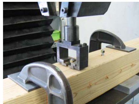
図 7. 杉角材の試験詳細
