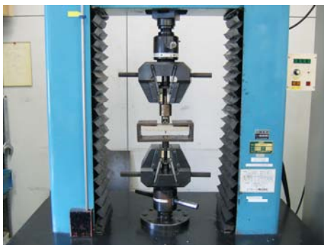
図 8. 耐火野地板の試験方法
