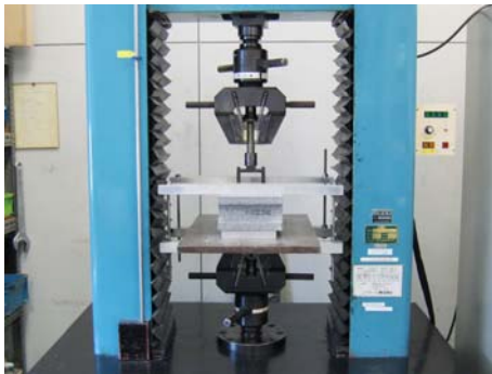
図 1 2 . 軽量・重量ブロックの試験方法
