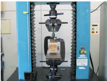
図 6. 杉角材の試験方法
