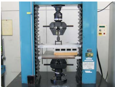
図 1 4 . 押出成形セメント板の試験方法
