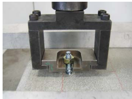
図 1 5 . 押出成形セメント板の試験詳細
