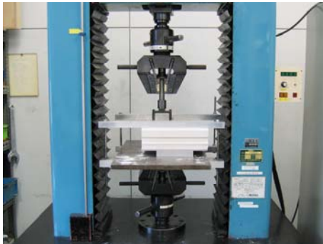
図 4. ALCの試験方法
