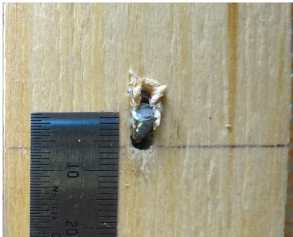
写真5 せん断破壊試料例
