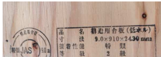
図 1 構造用合板 9 mm
