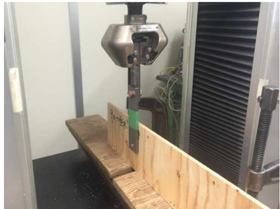
図 6 せん断試験写真
