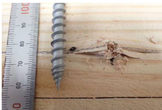
図5-2 実体引き抜き試験後の試験体外観(代表例) [タイトコース埋め込み深さ20 mm]
