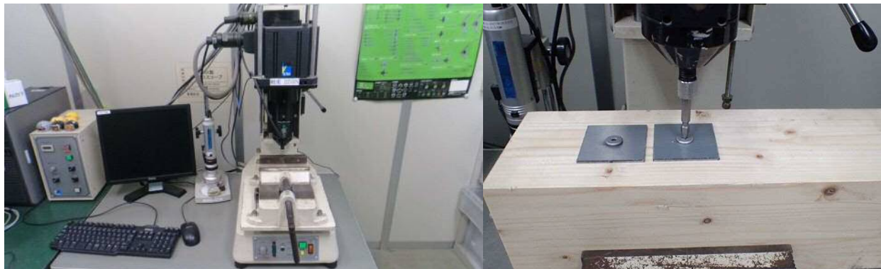
図4 トルクアナライザー外観及びにストリッピング試験の様子
