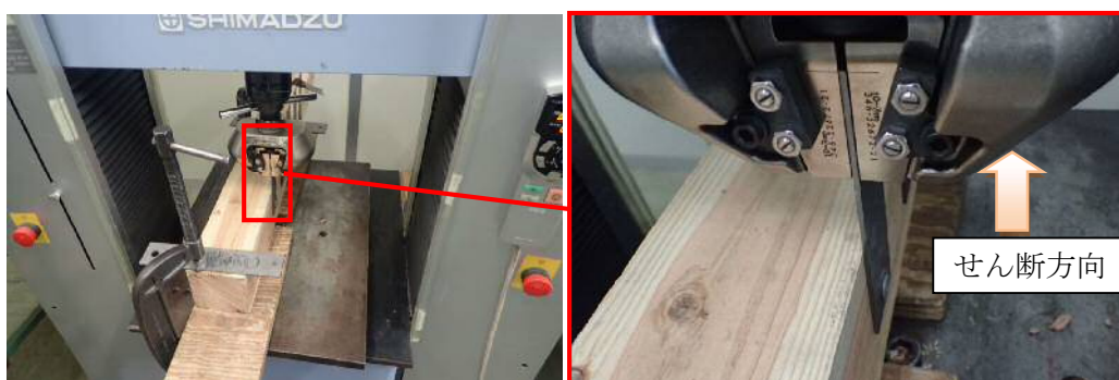
図3 実体せん断試験の様子
